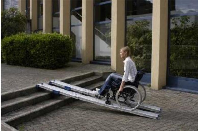
Die Rampen bestehen aus einem Paar Einzelschienen, die jeweils durch ein Scharnier in der Mitte faltbar sind und so nicht nur stufenförmige Hindernisse überbrücken, sondern auch Türschwellen und vergleichbare Erhöhungen. Für den Transport können die beiden Schienen auf die Hälfte ihrer Gesamtlänge zusammengefaltet werden.
